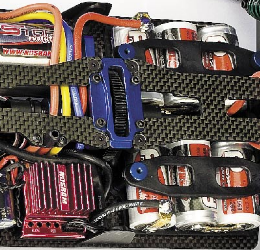
Die oberen Querlenker sind in der Versteifungsplatte gelagert
