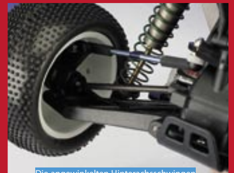
Die angewinkelten Hinterachsschwingen aus dem B4-Buggy
