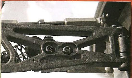
Die Querlenkerbefestigungen können durch Verschieben fein eingestellt werden
