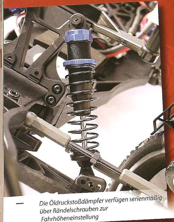
Die Öldruckstoßdämpfer verfügen serienmäßig über Rändelschrauben zur FahrhöhenEinstellung
