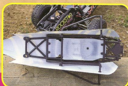
Die aufwendig mit Gitterrohrrahmen verstärkte Karosserie des SCB
