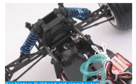
Der hintere Bulkhead mit eingebautem Differential. Die farbigen Alu-Buchsen sind standard
